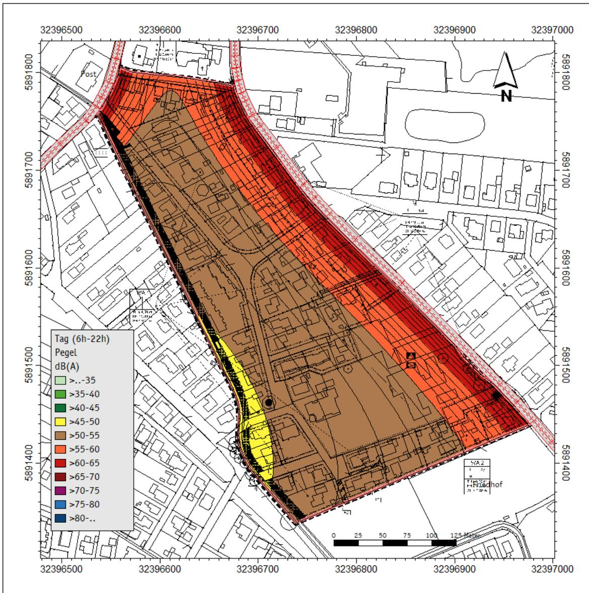
Abbildung 3: Rasterberechnung der Beurteilungspegel tagsüber, relative Höhe 7,60 m (2. OG) für das Prognosejahr 2035.
