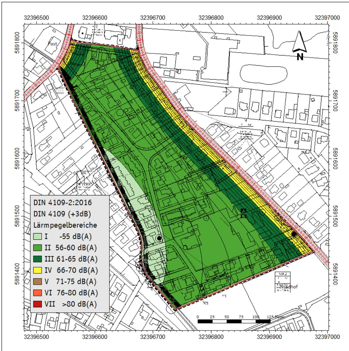
**Abbildung B.2:** Lärmpegelbereiche nachts (+10 dB(A)) nach DIN 4109-1 und -2, relative Höhe 4,80 m (1. OG).
