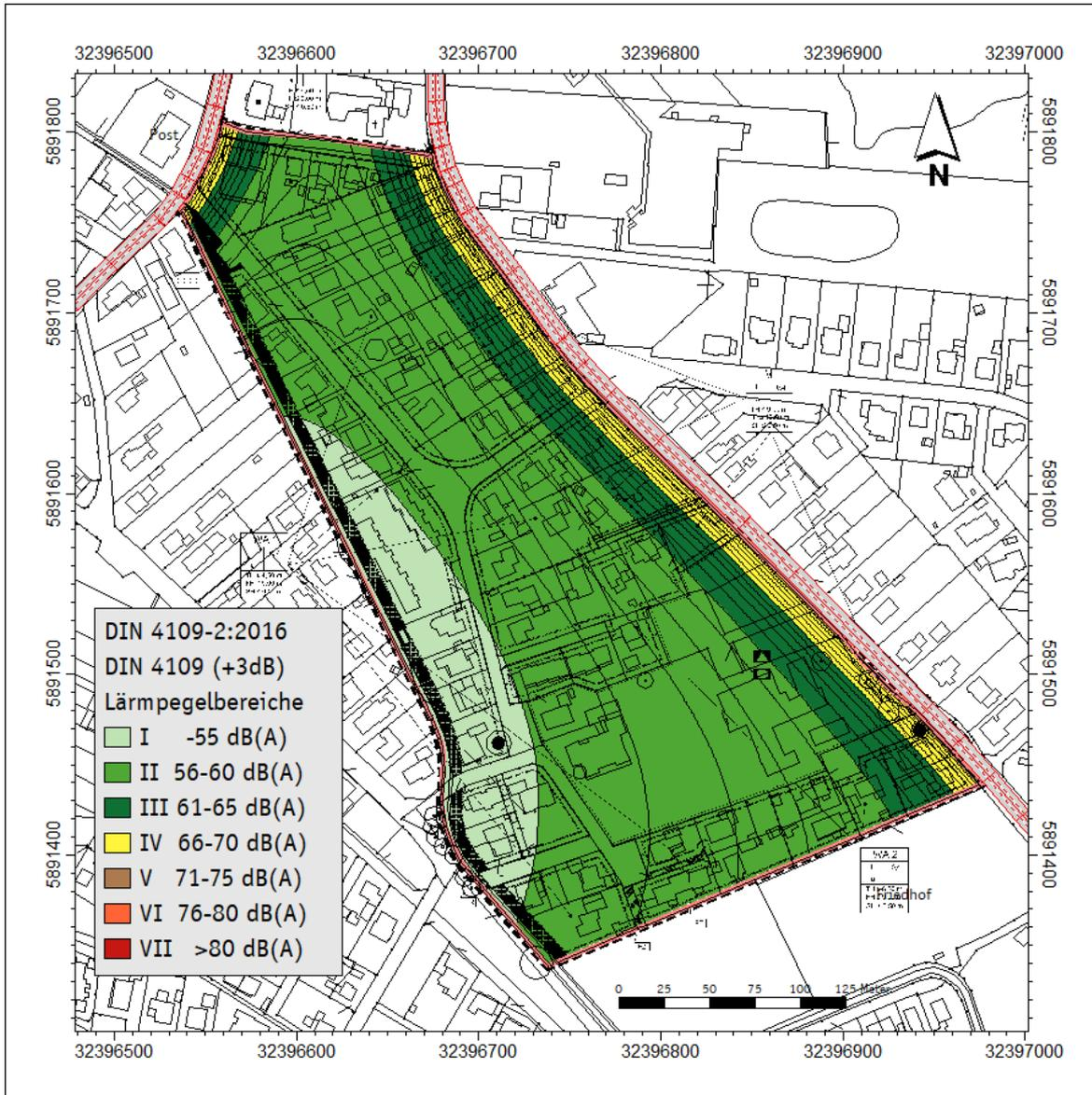
**Abbildung B.1:** Lärmpegelbereiche nachts (+10 dB(A)) nach DIN 4109-1 und -2, relative Höhe 2,00 m (EG).
