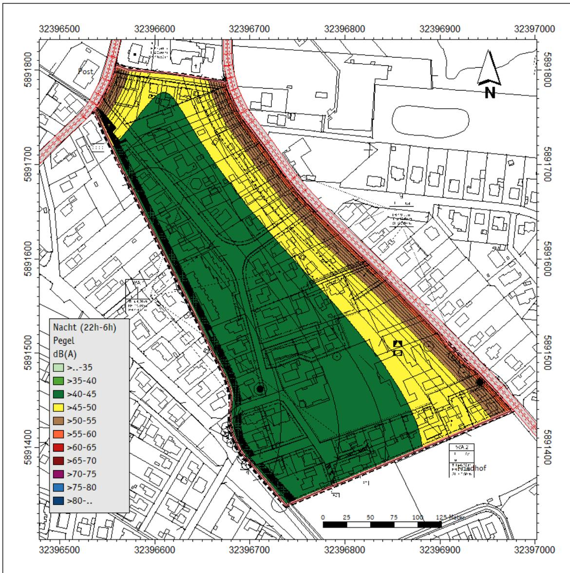
**Abbildung A.2:** Rasterberechnung der Beurteilungspegel nachts, relative Höhe 2,00 m (EG) für das Prognosejahr 2035.
